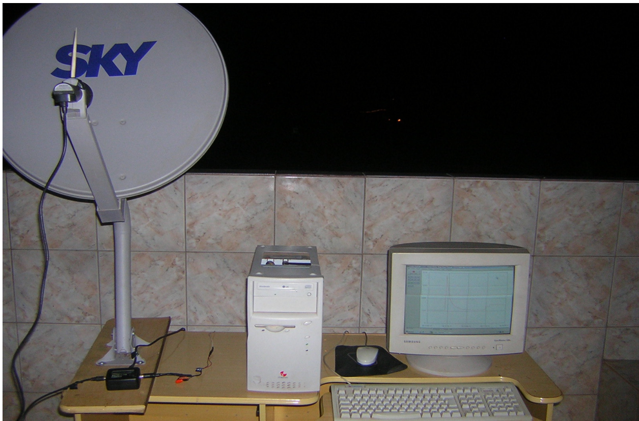
Figura 5. Radiotelescópio à baixo custo, resultado do trabalho de conclusão de curso de estudante da Universidade Católica de Brasília.
